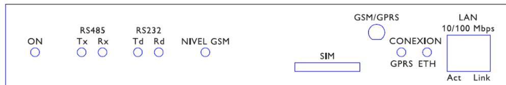
Fig. 2.1 Disposición de elementos en zona frontal.
