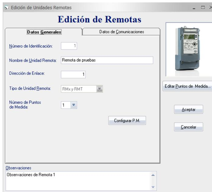
Fig. 5.1.2.4-1: Ventana de Datos Generales de la Unidad Remota (Protocolo IEC-870)
