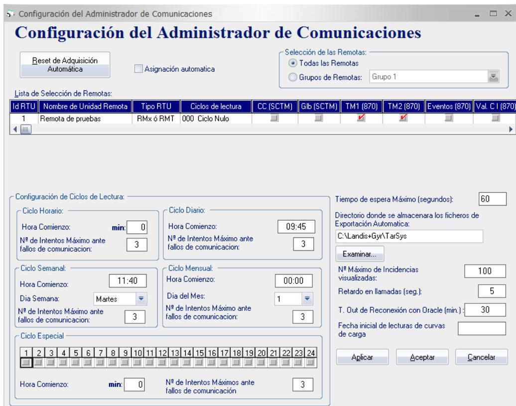
Fig. 6.2-1. Configuración de la Adquisición Automática.
